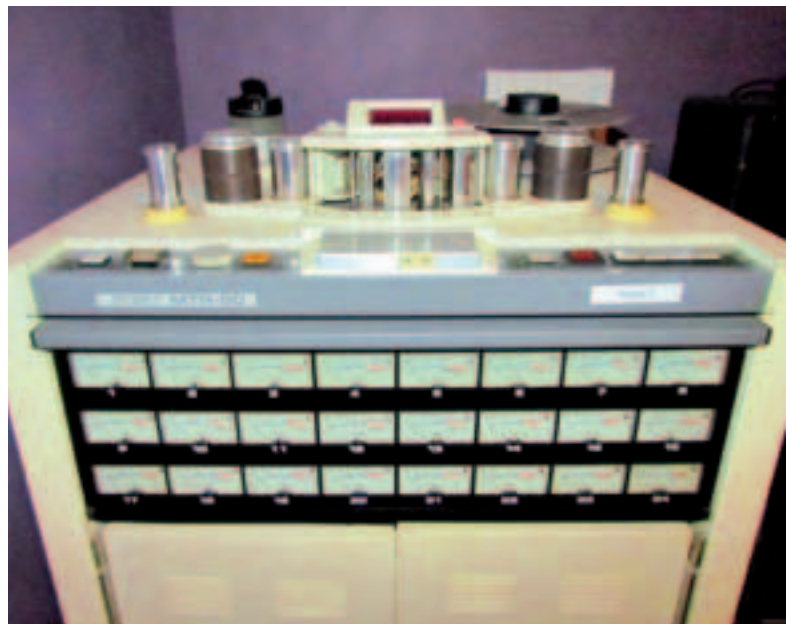
Zwei Otari 24-Spur-Zweizollmaschinen verrichten im Woodhouse auch heute noch regelmäßig ihren Dienst
